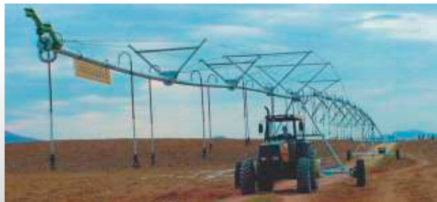
Torre em posição de rebocagem pelo balanço (2 rodas)
